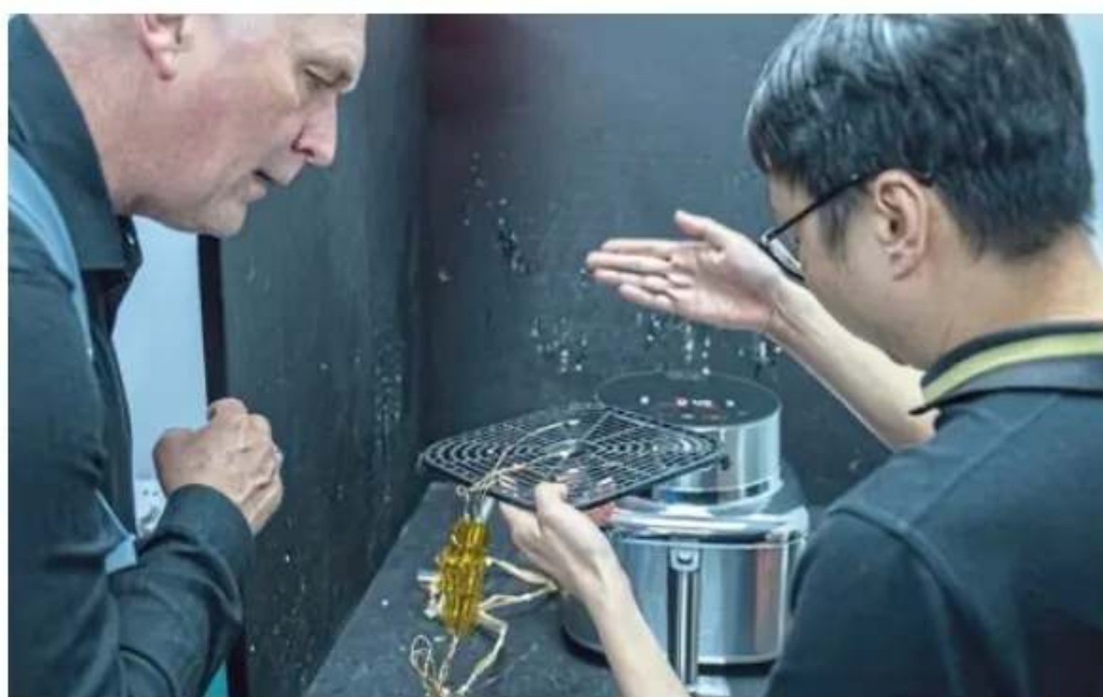
¿La distribución de la temperatura es realmente óptima? En el laboratorio de pruebas de VeSync, las airfryers Cosori se someten constantemente a distintos ensayos de resistencia para lograr comprobarlo.
